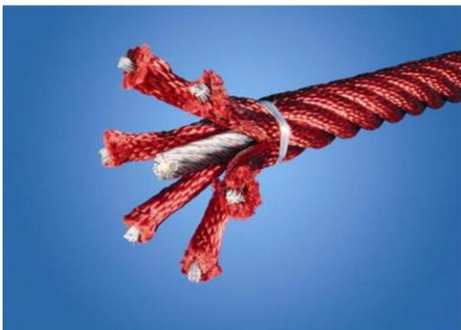
Веревки Corogcord диаметром 19 мм и более - это особый тип «Геркулес» с оцинкованными шестистручными стальными проволоками. Каждая нить плотно обмотана нитью PES, которая расплавляется на каждую индивидуальную прядь. Веревки обладают высокой стойкостью к износу и устойчивостью к вандализму. При необходимости могут быть заменены на месте.
