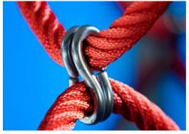
Зажимы Corocord 'S' используются в качестве универсальных соединений в изделиях Corocord. 8-миллиметровые стержни из нержавеющей стали с закругленными краями прижимаются к канатам с помощью специального гидравлического пресса, что делает их идеальным соединителем: безопасным, долговечным и защищенным от вандализма, и в то же время допускающим обычное движение игровых канатных
