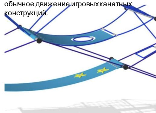
Мембранны Corocord состоят из износостойкого прорезиненного материала конвейерного качества с отличной стойкостью к ультрафиолетовому излучению. Протестировано и соответствует требованиям REACH для ЛАГ. Закладка представляет собой четырехслойную броню из тканого полиэстера. В результате армирования и двух поверхностных слоев общая толщина составляет 7,5 мм.
