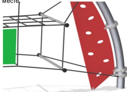
Панель изготовлена из 19-мм EсоCore™ HDPE. Этот высокопрочный, экологичный материал не только подлежит вторичной переработке после использования, но также состоит из сердечника, изготовленного из 100% переработанного материала.
