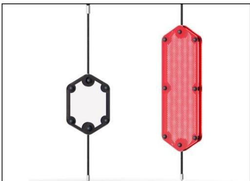
Поворотные оптические панели из двух поликарбонатных пластин толщиной 7 мм с расстоянием 25 мм. Внутренний графический принт состоит из слоя изображения и внешнего прозрачного защитного слоя. И панель ПК, и лак на водной основе устойчивы к ультрафиолетовому излучению, чтобы предотвратить выцветание принта.
