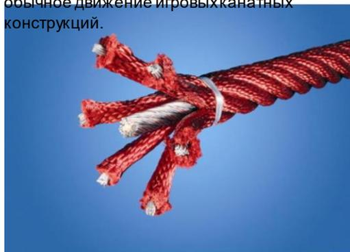
Веревки Согорсод диаметром 19 мм и более - это особый тип «Геркулес» с оцинкованными шестистручными стальными проволоками. Каждая нить плотно обмотана нитью PES, которая расплавляется на каждую индивидуальную прядь. Веревки обладают высокой стойкостью к износу и устойчивостью к вандализму. При необходимости могут быть заменены на месте.
