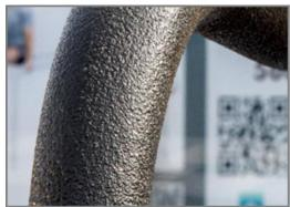
Покрытие полимочевина, используемое на всех рукоятках, обладает высокой износостойкостью, а также обеспечивает изоляцию и одновременно превосходное сцепление с поверхностью во время тренировки.
