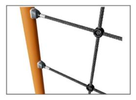
Канаты изготовлены из УФ-устойчивого PES с внутренним армированием стальным тросом. Канат подвергается индукционной обработке для создания прочного соединения междусталью и канатом, что приводит к хорошей износостойкости.
