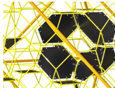
Зажимы Corocord 'S' используются в качестве универсальных соединений в изделиях Corocord. 8-миллиметровые стержни из нержавеющей стали с закругленными краями прижимаются к канатам с помощью специального гидравлического пресса, что делает их идеальным соединителем: безопасным, долговечным и защищенным от вандализма, и в то же время допускающим обычное движение игровых канатных конструкций.
