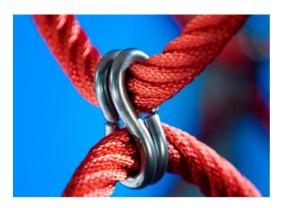
Зажимы Corocord 'S' используются в качестве универсальных соединений в изделиях Corocord. 8-миллиметровые стержни из нержавеющей стали с закругленными краями прижимаются к канатам с помощью специального гидравлического пресса, что делает их идеальным соединителем: безопасным, долговечным и защищенным от вандализма, и в то же время допускающим
