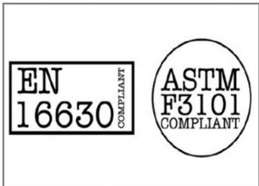
Все фитнес-продукты KOMPAN соответствуют стандартам ASTM F3101 и EN16630 для фитнеса на открытом воздухе. Нагрузочные тесты выполняются в виде статического теста путем добавления динамических факторов, а также факторов безопасности к указанной нагрузке в 78 кг на пользователя. Продукт, предназначенный для 1 пользователя, загружен 420 кг.
