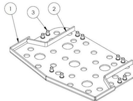
Внутри SBR отливается плита из оцинкованной углеродистой стали толщиной 5 мм, чтобы обеспечить оптимальную устойчивость и оптимизировать монтаж ступеньки к раме.
