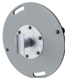
Подшипниковый вал изготовлен из нержавеющей стали AISI304. Сам подшипник изготовлен из полиоксиметилена (POM), инженерного термопластика с высокой жесткостью, низким трением и отличной стабильностью размеров.
