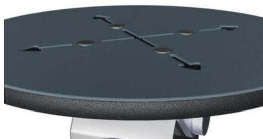
Верхняя 414 мм пластина изготовлена из 15 мм Ecodgr, 15 мм полиэтиленовой пластины с 3 мм верхним слоем из термопластичной резины с противоскользящим эффектом. Высота 217 мм, диапазон движения +/- 90 мм, с резиновым упором EPDM на каждом конце.
