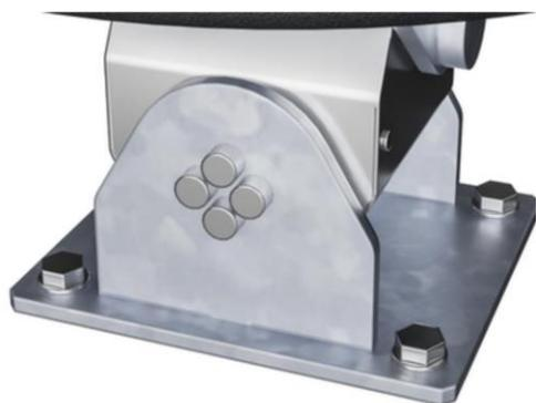
Двойной элемент ROSTA изготовлен из литого железа и оцинкован горячим способом до окрашивания. Это гарантирует, что элемент ROSTA представляет собой не требующий обслуживания эластичный шарнир, который можно перемещать в диапазоне движения 250 в любом направлении. Оба колебания имеют разную жесткость, разница составляет 45%.
