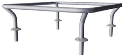
Поручни, предназначенные в качестве ручек во время упражнений, изготовлены из оцинкованной стали толщиной 38 мм, большого диаметра для хорошего сцепления и поддержки запястья. Высота поручня составляет 940 мм от верхней части плиты HPL. Расстояние между поручнями составляет 900 мм.
