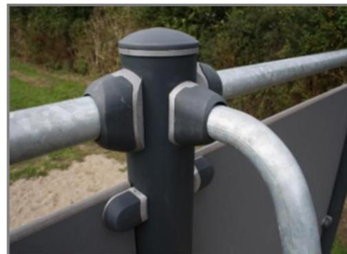
Разъемы изготовлены из литого под давлением алюминия, специально легированного для наружных условий и интенсивного использования. Винты крепления разъемов выполнены из нержавеющей стали и защищены цинковыми шайбами.
