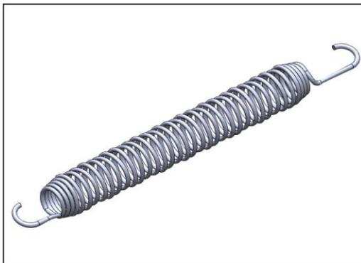
Все 36 пружин изготовлены из нержавеющей стали, что обеспечивает долговечность и отличную коррозионную стойкость. Толщина стальной проволоки составляет 3,2 мм, а последние пять витков имеют коническую форму, что обеспечивает долгий срок службы.
