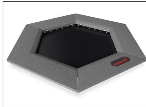
Плитка отлита из серого гранулированного вторичного каучука (SBR / NR), а логотип КОМПАН сделан из этилен-пропилен-диенового мономера EPDM. Внутри каждой из резиновых плиток находится стальная пластина толщиной 3 мм, оцинкованная горячим способом.
