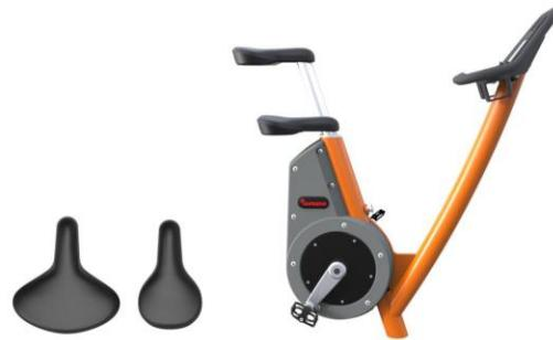
Седло изготовлено из полиуретановой резины и имеет стальную вставную пластину, которая соединяется с алюминиевым штифтом. Седло можно отрегулировать, установив его на 13 разных высотах, используя шплинт из нержавеющей стали.
