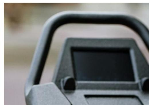
Рукоятки специально разработаны для нескольких положений рук, чтобы приспособить разные положения и стили езды. Это литая алюминиевая деталь с покрытием из полимочевины для хорошего сцепления и изоляции.
