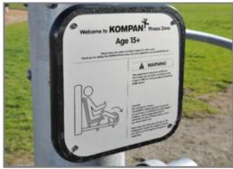
Знак состоит из 1,5-миллиметровой алюминиевой пластины с шелкографической печатью, запечатанной в результате последующего процесса анодирования, привинченной к обработанной пластине из 19-мм EcoCore.
