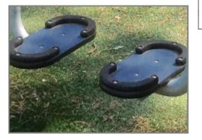
Педали изготовлены из стали, оцинкованной горячим способом, с пластиной для педалей, изготовленной из панелей Ekogrip из 15-мм полиэтилена с верхним слоем из термопластичной резины толщиной 3 мм. Это обеспечивает нескользящий эффект для комфортной и безопасной тренировки при любых погодных условиях.
