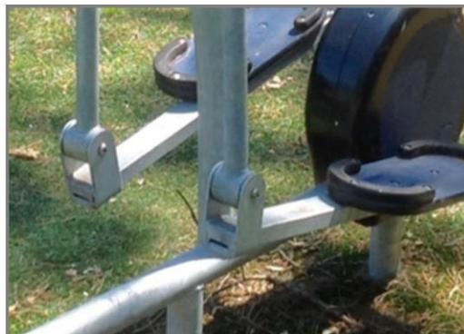
Рама и движущиеся стальные детали изготовлены из стальных труб горячего цинкования размером 60,3 мм x 3,2 мм, 38 мм x 4 мм и трубы прямоугольной формы 60 x 30 x 3 мм. Все подвижные соединения имеют вал из нержавеющей стали AISI 304 и два шариковых подшипника.
