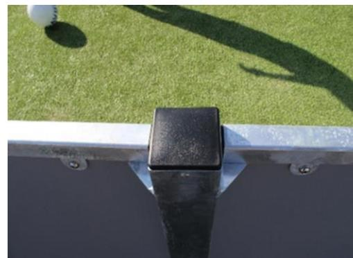
Опоры изготовлены из профиля 80x80x3 мм с горизонтально сварными 6 мм фланцами. Это позволяет легкую установку и прочную конструкцию. Заглушки из полиэтилена низкой плотности крепятся глухими заклепками.
