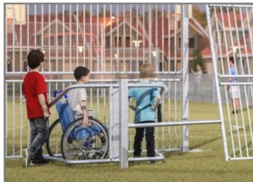
Вход для пользователей инвалидных колясок создан из опоры 80 x 80 x 3 мм с 48 мм трубой и 2-мя 16 мм петлями из нержавеющей стали. Ширина проема 95 см и длина 112 см, что позволят пользователем инвалидных колясок легко попасть в MUGA, но в то же время не позволяет проход пользователям мопедов и мотоциклов.
