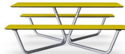
Стальные поверхности оцинкованы горячим способом внутри и снаружи. Оцинковка имеет отличную стойкость к коррозии на открытом воздухе и не требует высоких эксплуатационных расходов. Окрашенные стальные детали оцинковываются горячим способом, после чего покрываются порошковым слоем. Размер стальной трубы: Ø 48,3 x 3,2 мм.
