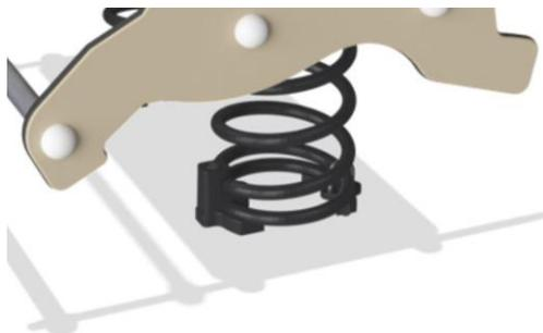
Пружины KOMPAN изготовлены из высококачественной пружинной стали в соответствии с EN10270. Пружины очищаются путем фосфатирования перед нанесением эпоксидной грунтовки и полиэфирного порошкового покрытия. Пружины фиксируются уникальными противозадирными фитингами для максимальной безопасности и длительного срока службы.
