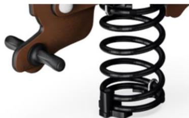
Пружины КОМПАНИ изготовлены из высококачественной пружинной стали в соответствии с EN10270. Пружины очищаются путем фосфатирования перед нанесением эпоксидной грунтовки и полиэфирного порошкового покрытия. Пружины фиксируются уникальными противозадирными фитингами для максимальной безопасности и длительного срока службы.
