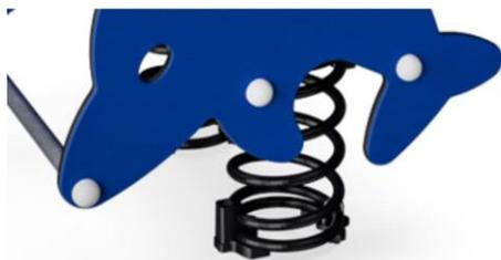
Пружины KOMPAN изготовлены из высококачественной пружинной стали в соответствии с EN10270. Пружины очищаются путем фосфатирования перед нанесением эпоксидной грунтовки и полиэфирного порошкового покрытия. Пружины фиксируются уникальными противозадирными фитингами для максимальной безопасности и длительного срока службы.
