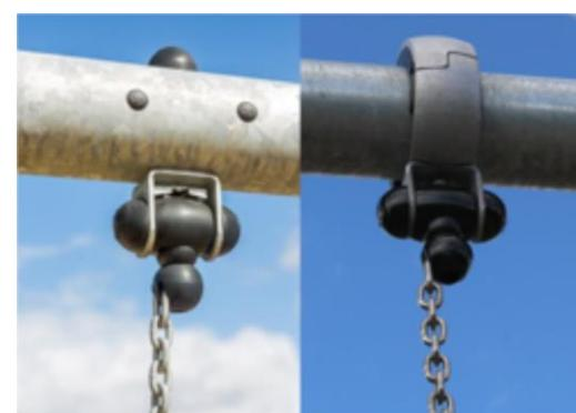
Подвески для качелей изготовлены из высококачественного нейлонового (PA6) корпуса с УФ-стабилизацией и встроенными герметичными шариковыми подшипниками. Регулируемые по высоте цепи фиксируются крюком из нержавеющей стали с защищенными от кражи болтами «змеиный глаз» в поворотном корпусе с защитой от скручивания. Все сиденья с фиксацией двух цепей доступны со стандартной подвеской или подвеской с функцией анти-
