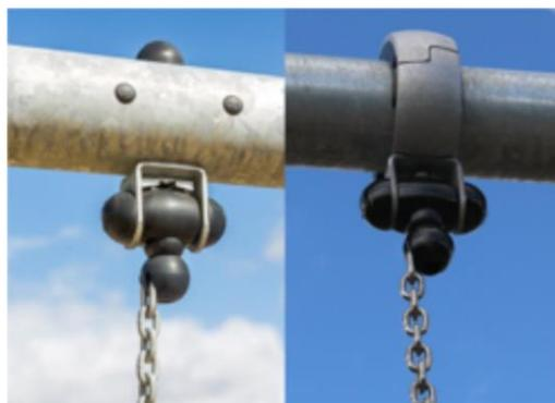
Подвески для качелей изготовлены из высококачественного нейлонового (РА6) корпуса с УФ-стабилизацией и встроенными герметичными шариковыми подшипниками. Регулируемые по высоте цепи фиксируются крюком из нержавеющей стали с защищенными от кражи болтами «змеиный глаз» в поворотном корпусе с защитой от скручивания. Все сиденья с фиксацией двух цепей доступны со стандартной подвеской или подвеской с функцией анти-
