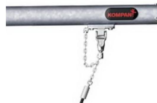
Разработанные KOMPAN подвески для качелей из нержавеющей стали с функцией анти-закручивание. Подвески крепятся к поперечной балке на сварном кронштейне с помощью двух болтов. Подшипники залиты силиконовой смазкой и не требуют дополнительной смазки.
