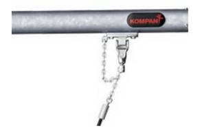
Разработанные КОМРАN подвески для качелей из нержавеющей стали с функцией анти-закручивание. Подвески крепятся к поперечной балке на сварном кронштейне с помощью двух болтов. Подшипники залиты силиконовой смазкой и не требуют дополнительной смазки.
