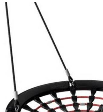
Разработанные КОМПАН подвески для качелей из нержавеющей стали с функцией анти-закручивание. Подвески крепятся к поперечной балке на сварном кронштейне с помощью двух болтов. Подшипники залиты силиконовой смазкой и не требуют дополнительной смазки.
