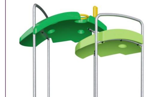
Крыши структур ELEMENTS изготовлены из перерабатываемого PE с минимальной толщиной стенки 5 мм, что обеспечивает высокую долговечность в любых климатических условиях по всему миру. Стальные трубы оцинкованы методом горячего цинкования внутри и снаружи для максимальной прочности.
