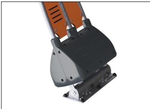
Качающееся движение вперед и назад контролируется усиленным масштабируемым двойным резиновым пружинным элементом кручения. Резиновый элемент обеспечивает безопасное движение и снижает скорость движения к платформам башни. Основание сделано из формованного полиэтилена с высокой ударпрочностью.
