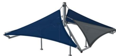
Паруса из коммерчески чистого полиэтилена высокой плотности 95 вазаы специально для солнцезащитных конструкций. Паруса обработаны ультрафиолетовыми стабилизаторами для обеспечения длительного срока службы. Паруса опираются на стальную раму, оцинкованную горячим способом, и затягиваются устройствами из нержавеющей стали.
