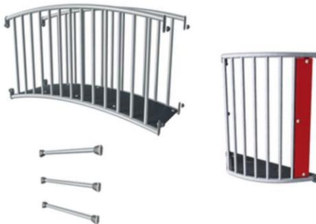
Палубы серии ELEMENTS изготовлены из HPL толщиной 17,8 мм и поддерживаются уникальной алюминиевой рамой с несколькими вариантами крепления с использованием алюминиевых разъемов. Основные стойки изготовлены из высококачественной предварительно оцинкованной стали с порошковым покрытием. Столбы закрыты крышками из УФ-стабилизированного нейлона (РА6).
