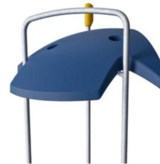
Крыши серии ELEMENTS изготовлены из переработанного полиэтилена с минимальной толщиной стенки 5 мм, чтобы обеспечить высокую долговечность во всех климатических условиях по всему миру. Стальные трубы оцинкованы горячим способом внутри и снаружи для максимальной прочности.
