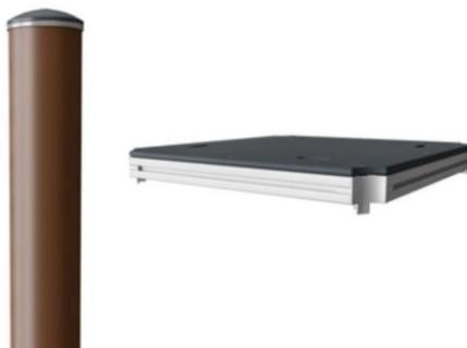
Палубы серии ELEMENTS изготовлены из HPL толщиной 17,8 мм и поддерживаются уникальной алюминиевой рамой с несколькими вариантами крепления с использованием алюминиевых разъемов. Основные стойки изготовлены из высококачественной предварительно оцинкованной стали с порошковым покрытием. Столбы закрыты крышками из УФ-стабилизированного нейлона (РА6).
