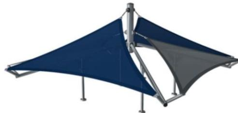
Паруса из коммерчески чистого полиэтилена высокой плотности 95 вазаны специально для солнцезащитных конструкций. Паруса обработаны ультрафиолетовыми стабилизаторами для обеспечения длительного срока службы. Паруса опираются на стальную раму, оцинкованную горячим способом, и затягиваются устройствами из нержавеющей стали.
