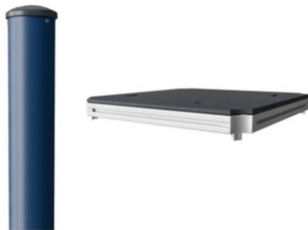
Палубы серии ELEMENTS изготовлены из HPL толщиной 17,8 мм и поддерживаются уникальной алюминиевой рамой с несколькими вариантами крепления с использованием алюминиевых разъемов. Основные стойки изготовлены из высококачественной предварительно оцинкованной стали с порошковым покрытием. Столбы закрыты крышками из УФ-стабилизированного нейлона (PA6).
