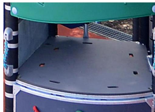
Все настилы опираются на сварную стальную раму из горячекатаной стали уникальной конструкции с несколькими вариантами крепления. Насыпи HPL толщиной 17,8 мм обладают очень высокой износостойкостью и уникальной нескользящей текстурой поверхности KOMPAN.
