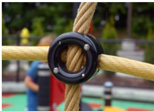
Альпинистские сетки изготовлены из стабилизированного ультрафиолетовым излучением полипропиленового троса с внутренним армированием стального троса. Канат подвергается индукционной обработке для обеспечения максимальной фиксации между сталью и канатом, что обеспечивает отличную износостойкость. Все соединители веревки изготовлены из 100% перерабатываемого РА материала.
