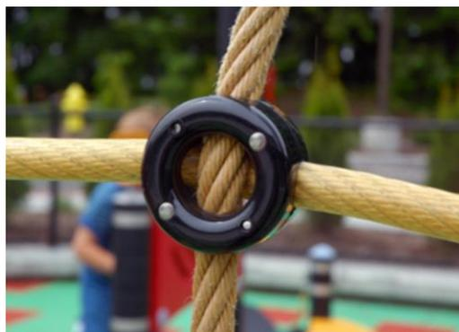
Альпинистские сетки изготовлены из стабилизированного ультрафиолетовым излучением полипропиленового троса с внутренним армированием стального троса. Канат подвергается индукционной обработке для обеспечения максимальной фиксации между сталью и канатом, что обеспечивает отличную износостойкость. Все соединители веревки изготовлены из 100% перерабатываемого PA материала.
