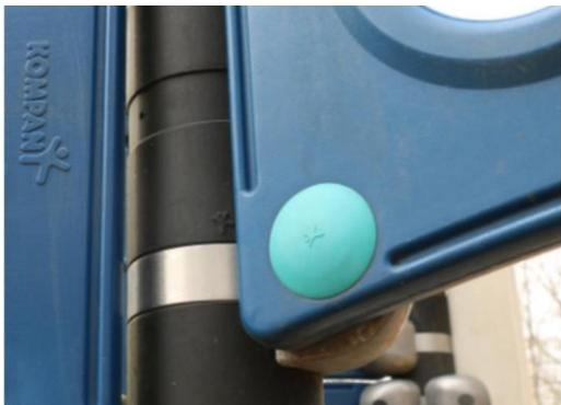
Основные опоры, представляющие собой 4-дюймовые предварительно оцинкованные с наружи и внутри стальные трубы с наружным слоем из полиуретановой резины толщиной 3 мм. Резина PUR отливается непосредственно на стальную трубу для обеспечения идеальной адгезии для длительного срока службы в любых климатических условиях.
