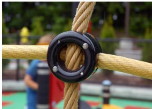
Альпинистские сетки изготовлены из стабилизированного ультрафиолетовым излучением полипропиленового троса с внутренним армированием стального троса. Канат подвергается индукционной обработке для обеспечения максимальной фиксации между сталью и канатом, что обеспечивает отличную износостойкость. Все соединители веревки изготовлены из 100% перерабатываемого PA материала.
