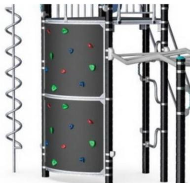
Изогнутая стена для лазанья изготовлена из панели Eкоgip, которая состоит из полиэтиленовой основы толщиной 15 мм с верхним слоем из мягкой резины толщиной 3 мм с противоскользящим эффектом.
