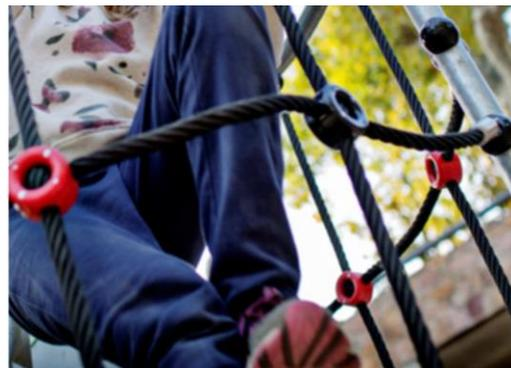
Сетки и тросы изготовлены из УФ-стабилизированного полиамида с внутренним усилением стального троса. Канат подвергается индукционной обработке для создания прочной связи между сталью и канатом. Это, в свою очередь, приводит к хорошей износостойкости.
