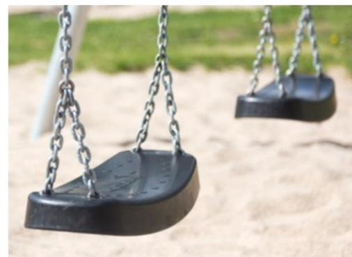
Стандартные сиденья качелей KOMPAN спроектированы для обеспечения максимальной безопасности и долговечности. Двухкомпонентное седло с внутренним сердечником из ПП и внешней резиной производится за одну операцию. Сиденья доступны с цепями из оцинкованной стали либо нержавеющей стали на любую высоту качелей.
