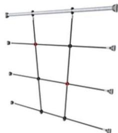
Сетки и тросы изготовлены из УФ-стабилизированного полиамида с внутренним усилением стального троса. Канат подвергается индукционной обработке для создания прочной связи между сталью и канатом. Это, в свою очередь, приводит к хорошей износостойкости.
