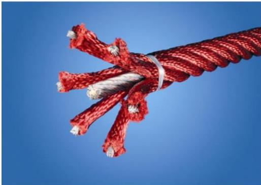
Веревки Corocord диаметром 19 мм и более - это особый тип «Геркулес» с оцинкованными шестистрочными стальными проволоками. Каждая нить плотно обмотана нитью PES, которая расплывается на каждую индивидуальную прядь. Веревки обладают высокой стойкостью к износу и устойчивостью к вандализму. При необходимости могут быть заменены на месте.
